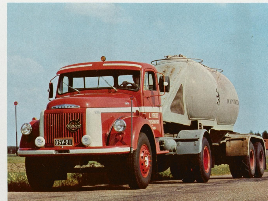
N 86-38 med 2-akslet sættevogn for cementtransport. TD 70. Dobbeltreduktions-bagtoøj. Sidekraftudtag.
