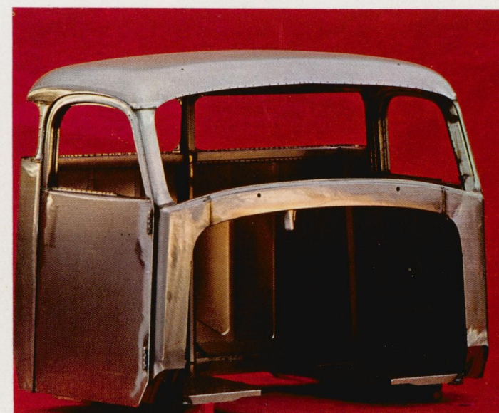
Volvo-førerhuset er hel-svejset over et stærkt skelet bestående af stålprofiler. Vindspejlet er af lamelglas og dørlåsene af sikkerhestypen.
