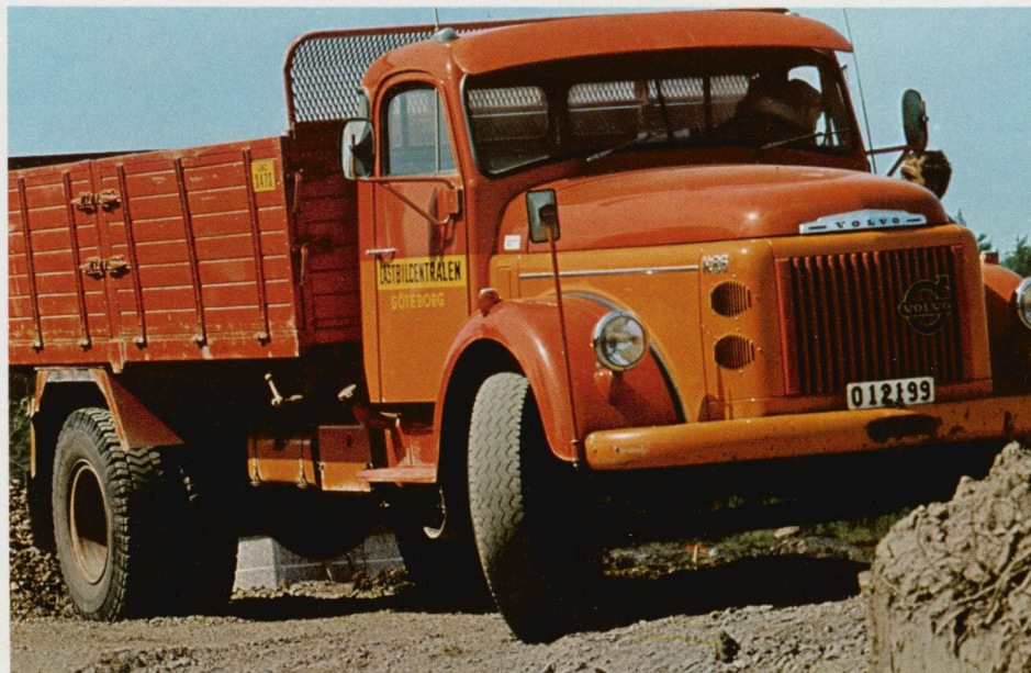
Store hjuludslag gør det nemt at manøvrere N/NB 86 selv på trange byggepladser.
