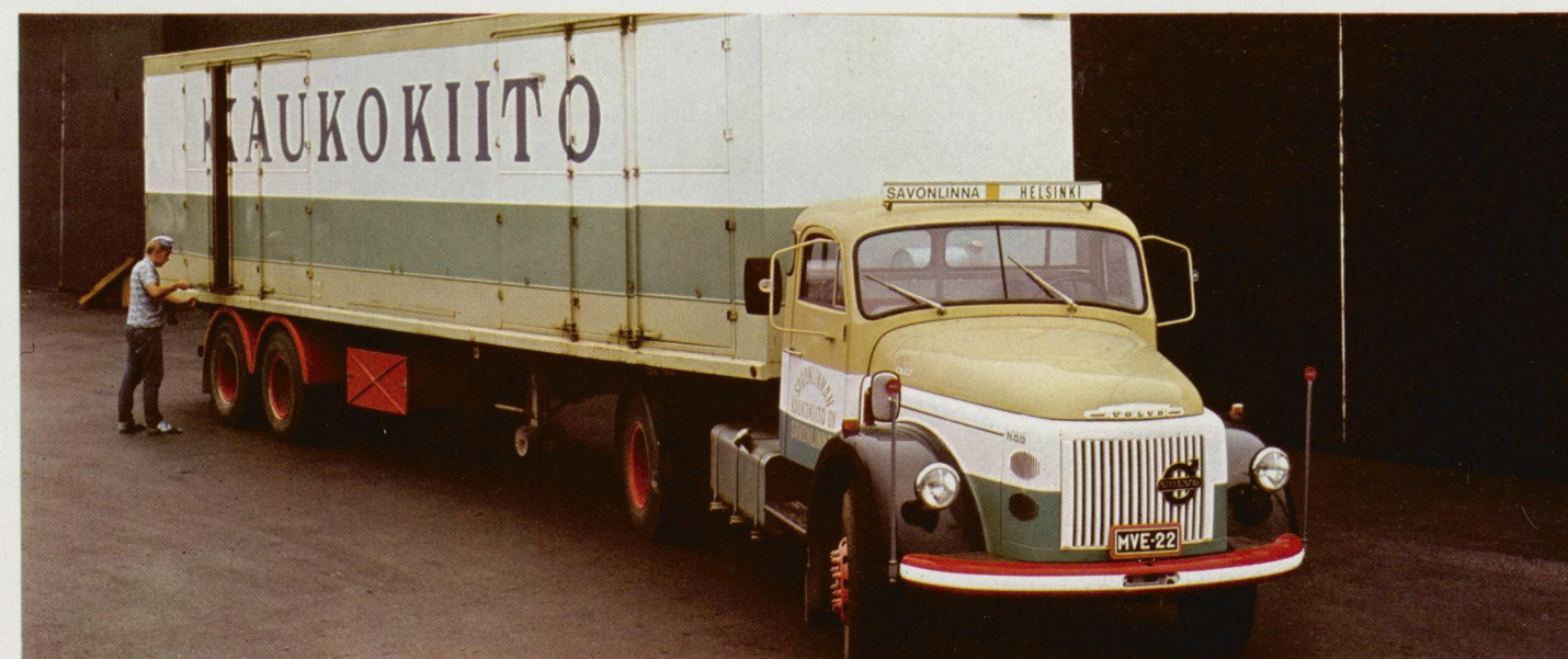
N 86-38 med 2-akslet sættevogn for stykgods i fjerntrafik. TD 70. Enkeltreduktions-bagtoøj.
