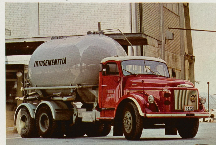
NB 86-44 med pulvertank for cementtransport. TD 70. Enkeltreduktions-bagtoøj. Sidemonteret kraftudtag.
