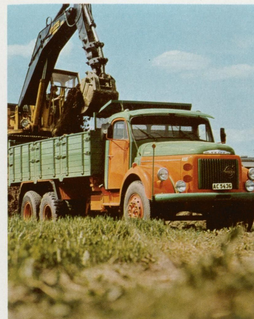
NB 86-44 med 3-vejs tip. TD 70. Dobbeltreduktions-bagtoøj. Bageste kraftudtag.
