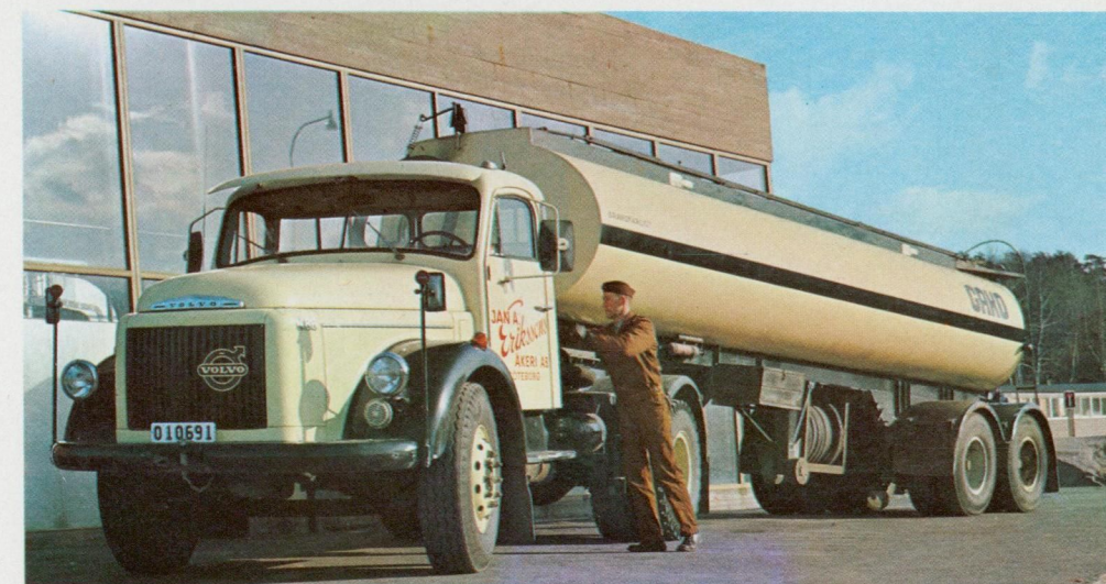
N 88-38 med tanksættevogn. TD 100. Dobbeltreduktion. Bageste kraftudtag.
