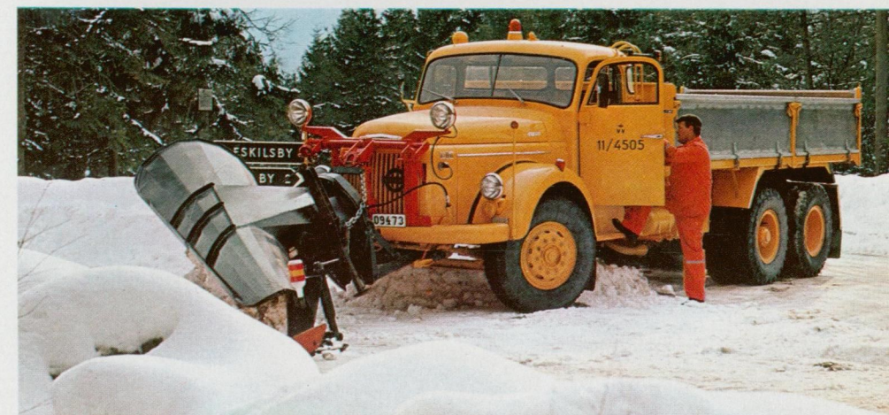
NB 88-34 med 3-vejs tip og sneplov. TD 100. Enkeltreduktion med navreduktion. Bageste kraftudtag.
