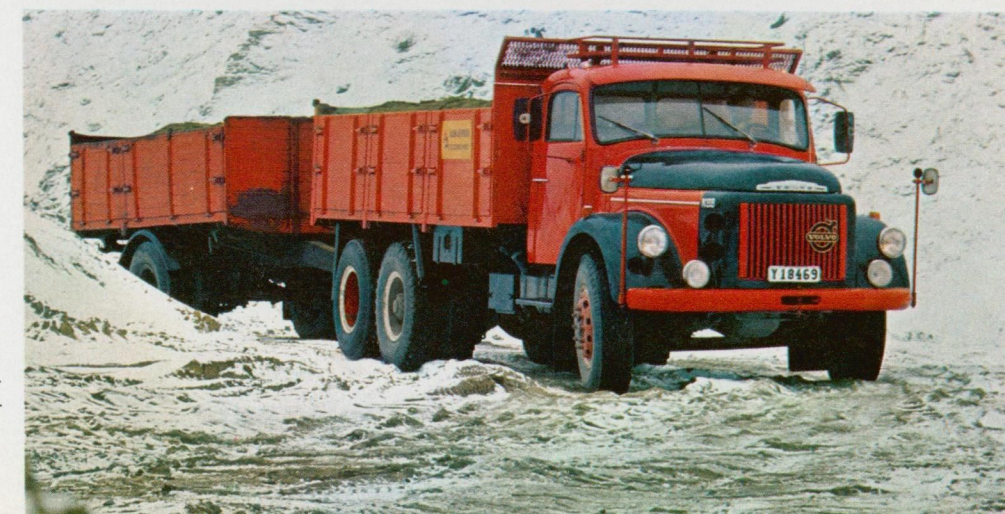
N 88-38 med 3-vejs tip og påhængsvogn. TD 100. Enkeltgearet med navreduktion. Bageste kraftudtag.
