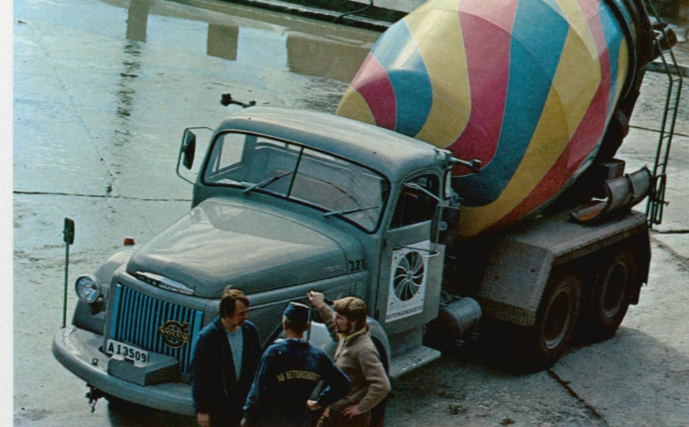
NB 88-44 med roterende betonmixer. TD 100. Enkeltgear med navreduktion. Frontmonteret hydraulpumpe.
