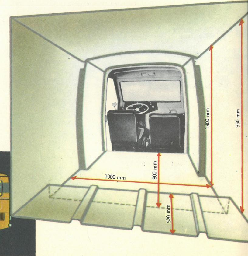
Sædet ved siden af chaufføren kan klappes helt til side, hvorved der bliver uhindret adgang til varerummet forfra.
