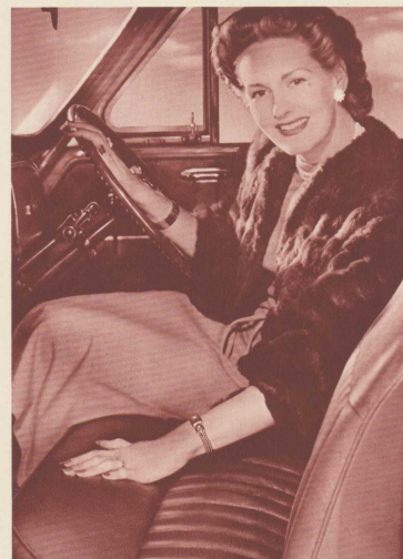
Morris Oxford's forsæde, der er af sofatyper, har tyk polstring af skumgummi over en fjederbund. Sædet er videnskabeligt konstrueret til at give kroppen den rigtige støtte og kan indstilles på et øjeblik.
