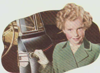
DOBBELT-VIRKENDE SIKKERHEDSLÅSE er monteret i alle døre. Hvis døren ikke er smækket rigtigt i, vil en sikkerhedspal holde den tillukket, indtil den bliver rigtigt lukket.
