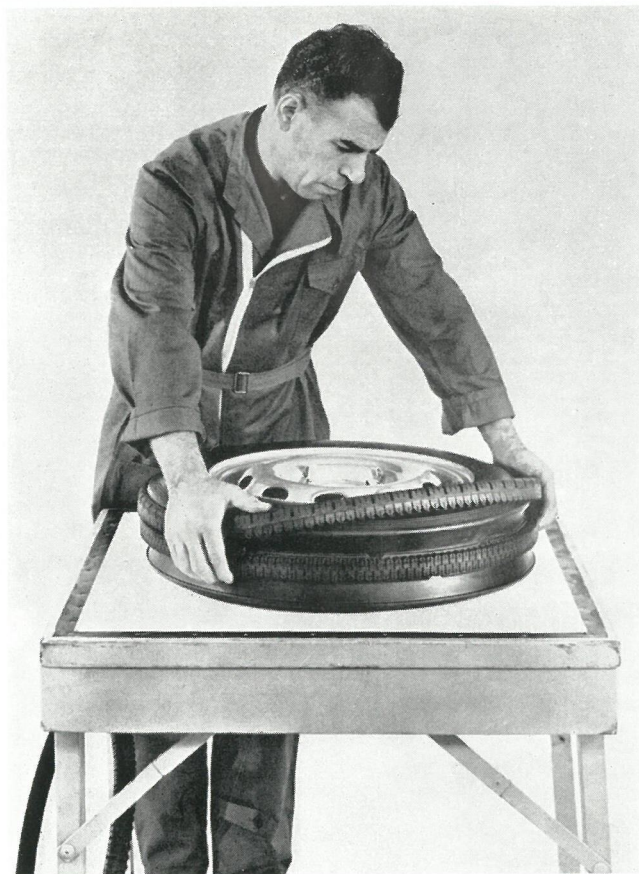
Herover ses, hvorledes man anbringer slidbanebæltterne på den uoppumpede karkasse. Billedet herunder er taget på skøjtebanen i Cortina d'Ampezzo, hvor man ser 2 vogne i et sving på isbelagt bane. Den sorte vogn er forsynet med Pirelli BS 3 dæk, og den hvide med almindelige dæk.
