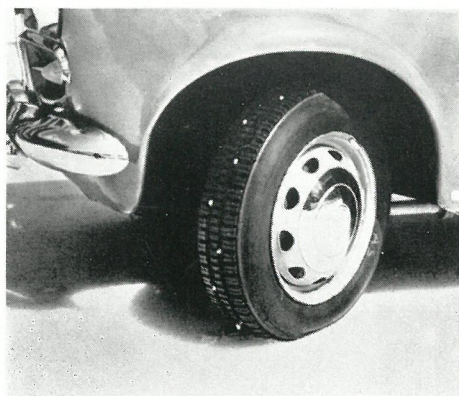
Nærbillede af Pirelli BS 3 dæk forsynet med ispigge; det ses, hvorledes dækket bider sig fast i isbanen.
