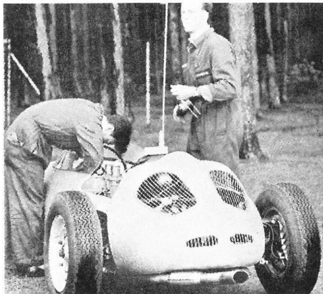
På Hockenheim udførtes forsøg med direkte måling af det dynamiske vindtryk. Målingen foretages ved hjælp af det høje slanke rør monteret bag førerens hoved.
