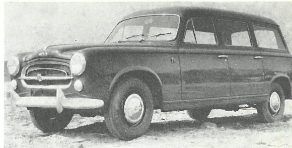
PEUGEOT 403 STATIONCAR 65 hk v. 4750 o.p.m., tophastig 125 km/t, slagvolumen 1468 ccm, kompression 7,3 : 1, vægt 1170 kg, benzinforbrug 11 l pr. 100 km.
