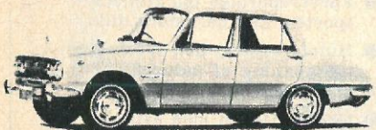
Isuzu Bellet. Længde: 401 cm. Vægt: 930 kg. 4-cylindret motor: 72 hk.
