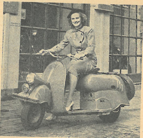
Pirol adskiller sig fra de øvrige scootere ved en motorstørrelse på 198 ccm. Tophastigheden opgives da også til 80 km/t.
