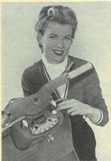
Instrumentbordet optages for største del af det store speedometer, i hvilket kontrollamper for ladestrøm og benzinereserve er indbygget.
