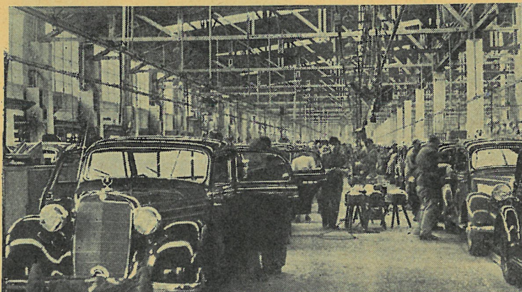
En af de store monteringshal- ler, hvor mo- del 170 S sam- les. Vognen i forgrunden er næsten færdig og vil snart forlade samle- båndet.
