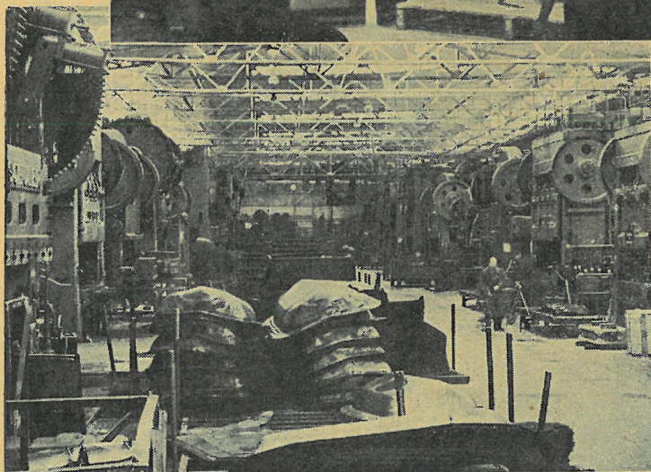
Et udsnit af de mægtige pres- ser, der frem- stiller karosse- riplader, skær- me o. s. v. Ma- skinerne er hypermoderne, og mange af dem er leveret på Marshall- hjælp.
