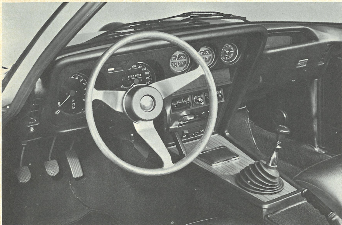
Interiør, instrumentering og indretning i det hele taget er praktisk i udformningen. Bemærk håndtaget til hovedlygterne – det er anbragt til venstre på midterkonsollen og ses bag ratkransen.
