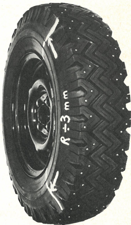
Det ekscentriske drivhjul, der afsatte accelerationsspor. På dækket er med hvidt markeret det udsnit af slidbanen, der havde ikke mindre end 3,0 mm mindre radius end den øvrige del af slidbanen.
