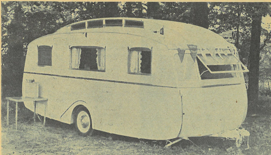
En tidsvarende campingvogn af normal og fornuftig konstruktion. Der er kun en dør, som er anbragt umiddelbart bag ved akslen, skylights, som giver fuld ståhøjde midt i vognen og skråt afskårne forhjørner i karosseriet således, at påhængsvognen kan monteres tæt ved motorvognen uden at støde på denne under skarpe drejninger.
