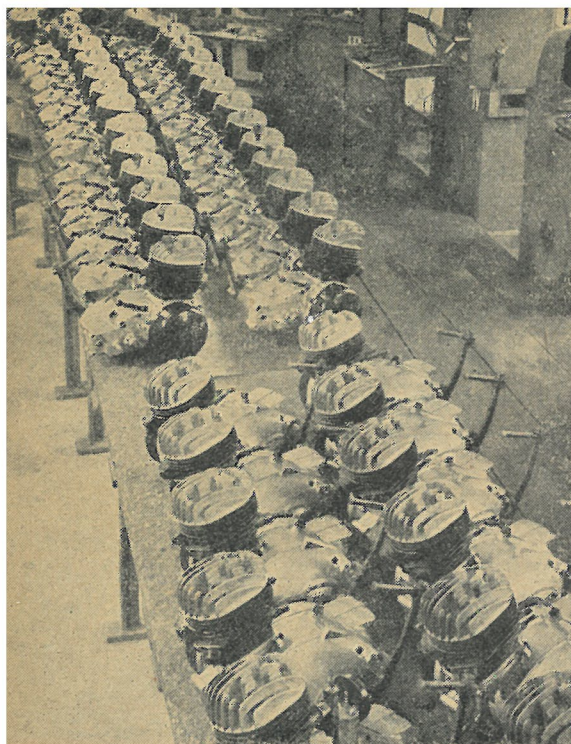
Fra samlebåndet går motorerne videre til prøverummet, hvor hver enkelt motor bliver afprøvet på dynamometer. Den første, vanskelige indkøring af motoren sker således også under betryggende forhold.
