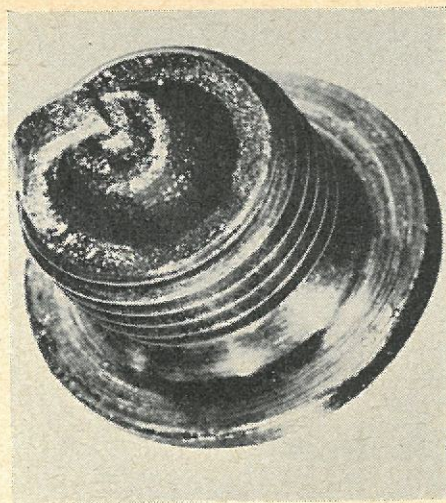
For høj temperatur i motorrummet skyldes i de fleste tilfælde for mager karburering. Tændrøret til venstre har haft det for varmt, hvilket ses af de stærkt forbrændte elektruder og den hvide eller grå isolator, der tillige kan have smelteperler eller som her ar efter forbrænding. Tændrøret til højre er tilset med olie, hvilket i reglen skyldes, at motoren er slidt, når der er tale om fire-taktmotorer. I alle tilfælde er det en forudsætning, at tændrørets glødetal er det for motoren foreskrevne.
