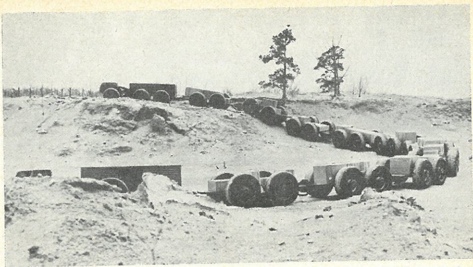
Dette her er kun for indehavere af absolut stort kørekort — en fiks lille ting med træk på alle 52 hjul. Vogntoget består af 12 enheder, og det er konstrueret til den amerikanske hær med transport i de arktiske egne og andre utilgængelige områder for øje.
