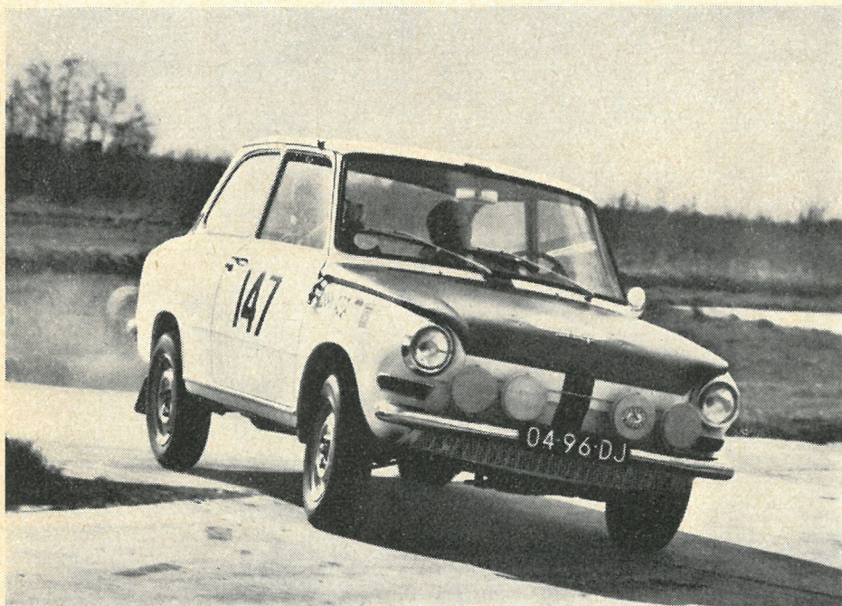
Dette er en DAF rally-model i fart rundt om et hjørne. Mærkelig nok valgte man en pendulakselophængning af baghjulene, men disse er indstillet på en sådan måde, at man slipper for denne baghjulsophængnings værste skavank. Bemærk det aflastede baghjul, der pænt bliver på kørebanelen, medens der er svag positiv camber på grund af krængningen.
