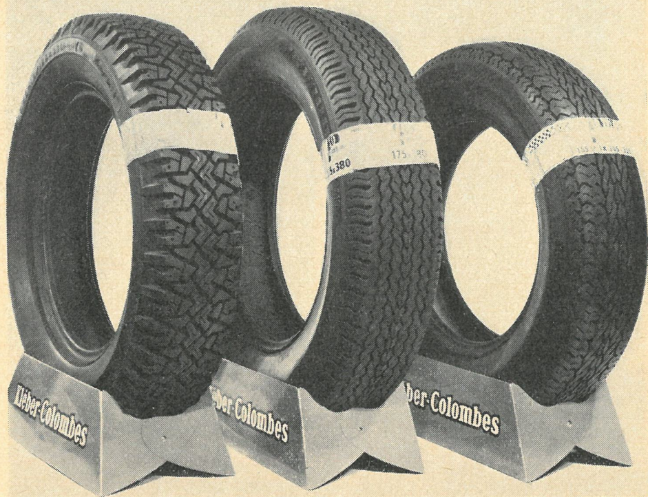
Her ses tre forskellige radialdæk fra Kléber-Colombes. Til venstre et vinterdæk, i midten det almindelige V 10 radialdæk og til højre V 10 GT radialdæk.
