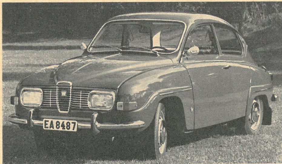
SAAB V4 1969 med ny kølergrill og firkantede lygter, men frem for alt med mange »indre« forbedringer. To-takt entusiastene betragter utvivlsomt V4 motoren som en gøgeunge, der har skubbet to-takteren ud.
