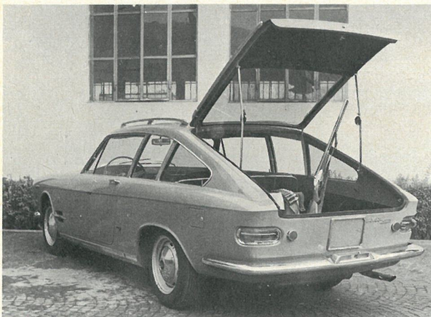
Ghia's Fiat 2300/S Club (de to billeder til venstre) kan med den store bagdør betegnes som en mellemting mellem en coupé og en sportspræget stationcar. Både i den og i Renault 16 (nederst t.h.) har man kombineret en funktionel og rummelig karrosseri-form med en hensigtsmæssig aerodynamisk udformning, selv om ingen af dem betegner nogen optimal løsning i den henseende.
