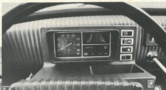
Til højre ses instrumentgruppen og den konsol, på hvilken de vigtigste kontakter sidder. Her under ses førerpladsen og det fortrinlige gearhåndtag samt til venstre for rattet chokeren og kontrolhåndtagene for varme og ventilation.
