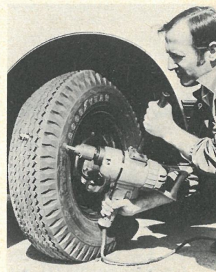
Når Good Year dækkene er fyldt med skum, er de pumpet op med en masse små luftceller, og de kan ikke punktere. Der vil gå mindst en halv snes år, før systemet er udviklet til personbiler.
