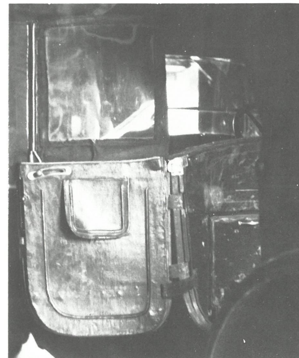
Détail intérieur d'une portière arrière, montrant entre autres le système de montage de la fenêtre entoîlée. Photo C.-H. T.
