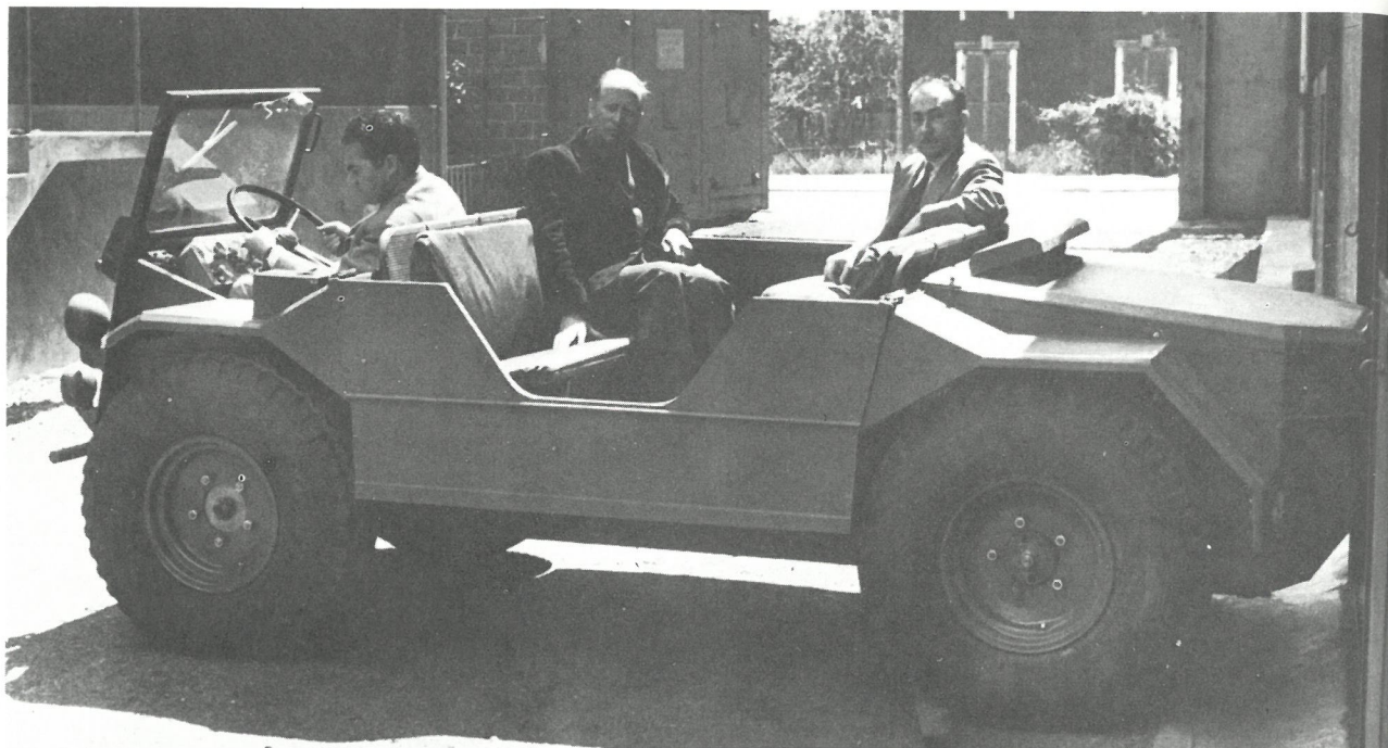
Victor Bouffort (au milieu en veste sombre) sur le prototype 01, avec des techniciens de Batignolles-Chatillon. Remarquez l'abatant gauche échancré, et le capot arrière avec un seul volet d'aération.
