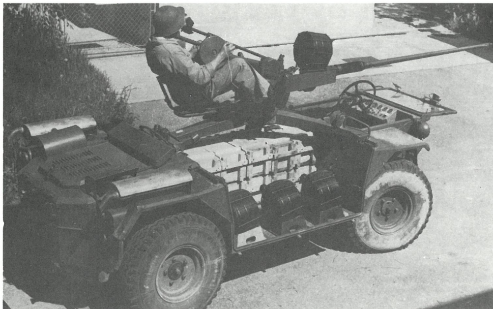
Autre vue du Bison essayé par l'armée helvétique avec canon de 20 mm Hispano-Suiza sur trépied.
