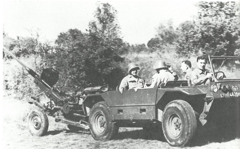
Lors d'essais par l'armée suisse, le Bison remorquant un canon automatique 20 mm Hispano-Suiza à chargeur tambour. Photos X. Collection V. Bouffort.
