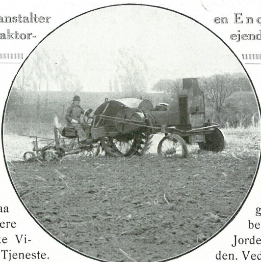
Ivel-Traktor med en tre-furet, selvløftende Plov.
