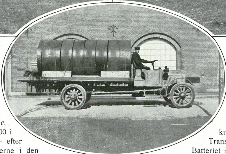
Et Lastautomobil med brede Hjulringe, som skydes ind over Kanonhjulene, naar Kanonerne skal transporterer hen over blød eller sandet Markjord.
