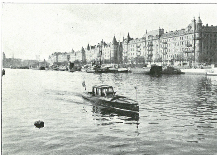
Hurtiggaaende Skærgaardsbaad med Skærm for Rorsmanden samt Skærm og Kaleche over Sidderummet.
